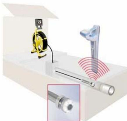
La posizione della telecamera e' rilevabile dalla superficie grazie alla presenza di una testa trasmittente rilevabile con il cercaservi RD4000 della Radiodetection.
