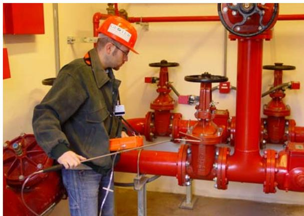
L'impiego dei gas tecnici costituisce una variante del metodo elettro-acustico e correlativo, per la localizzazione di piccole perdite, anche inferiori a 10 litri/ora. Trova applicazione nei casi di nuovi impianti (reti idriche, impianti antincendio, ecc.) che, durante il regolare esercizio o la fase di collaudo, non riescono a mantenere determinate pressioni in rete a causa di microperdite generate da difetti
