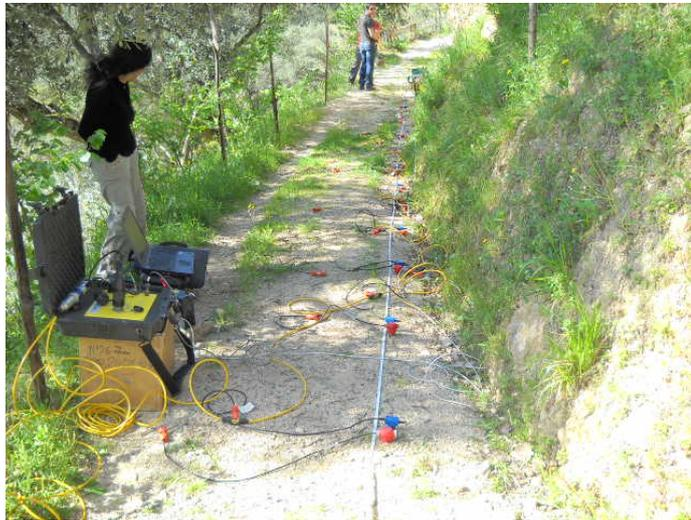
**TOMOGRAFIA SISMICA** consente la ricostruzione della stratigrafia, la valutazione dello spessore dello strato arenato superficiale, del grado di fratturazione della roccia, la presenza di faglie e cavità con sezioni bidimensionali ad alta densità.
