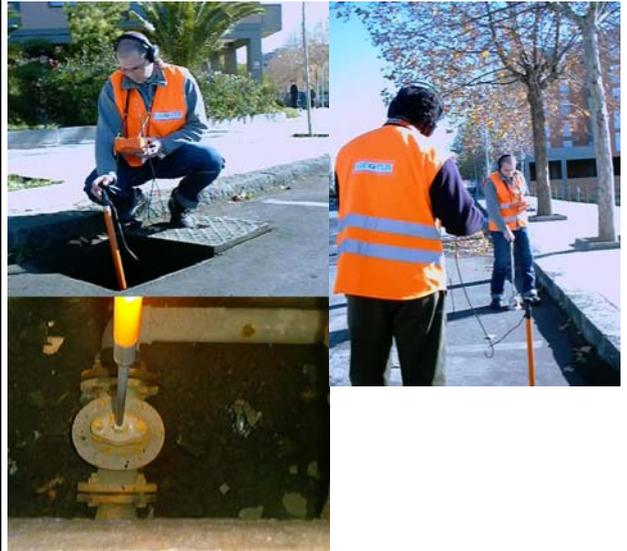
Localizzando il punto di massima intensità del rumore si individua esattamente la fuga d'acqua per ascoltazione diretta del rumore della perdita
