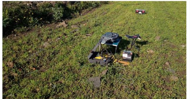
**APPLICAZIONI GEOELETTICHE:** i sondaggi elettrici verticali (S.E.V.) sono eseguiti usando la tecnica quadripolare Schlumberger e consentono la ricostruzione elettrostratigrafica dei terreni investigati. I campi di applicazione sono la ricerca di acque sotterranee e la stratigrafia dei siti. IDROTER, a richiesta, esegue **tomografie elettriche** per specifiche ricostruzioni di mappe 2D di resistività.
