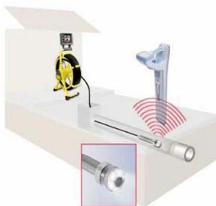
La posizione della telecamera è rilevabile dalla superficie grazie alla presenza di una testa trasmittente rilevabile con il cerca servizi RD4000 della Radiodetection.
