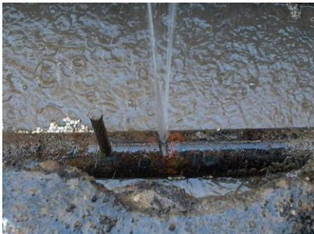
Localizzando il punto di massima intensità del rumore si individua esattamente la fuga d'acqua per ascoltazione diretta del rumore della perdita
