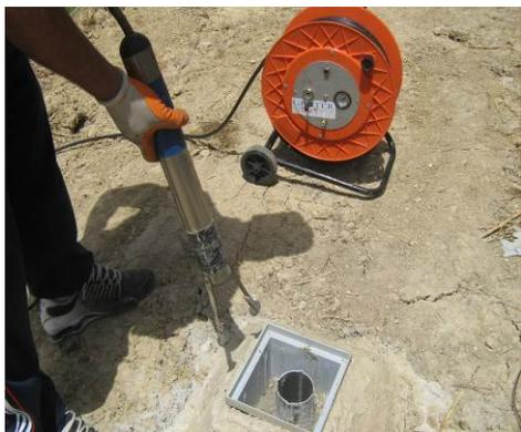
Si utilizzano speciali geofoni da foro a 5 o 3 componenti di registrazione, muniti di pistoncini per garantire un perfetto ancoraggio anche in presenza di fluido in foro ad elevato carico piezometrico.
