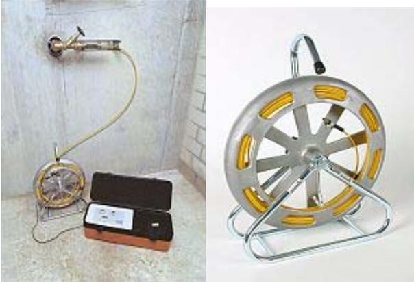
Le condotte in materiale plastico non sono localizzabili con il tradizionale metodo elettromagnetico, in quanto non conduttive elettricamente. Per ovviare a tale inconveniente si introduce una sonda in fibra di vetro conduttiva nella tubazione da localizzare si collega ai generatori dei cerca tubi e poi si procede come quando si cerca una tubazione metallica.
